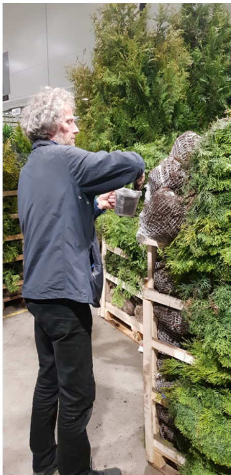
Prøvetaking av jord. Det blir tatt 10 x 1l fra hver kontainer. Foto: Anders Endrestøl.
