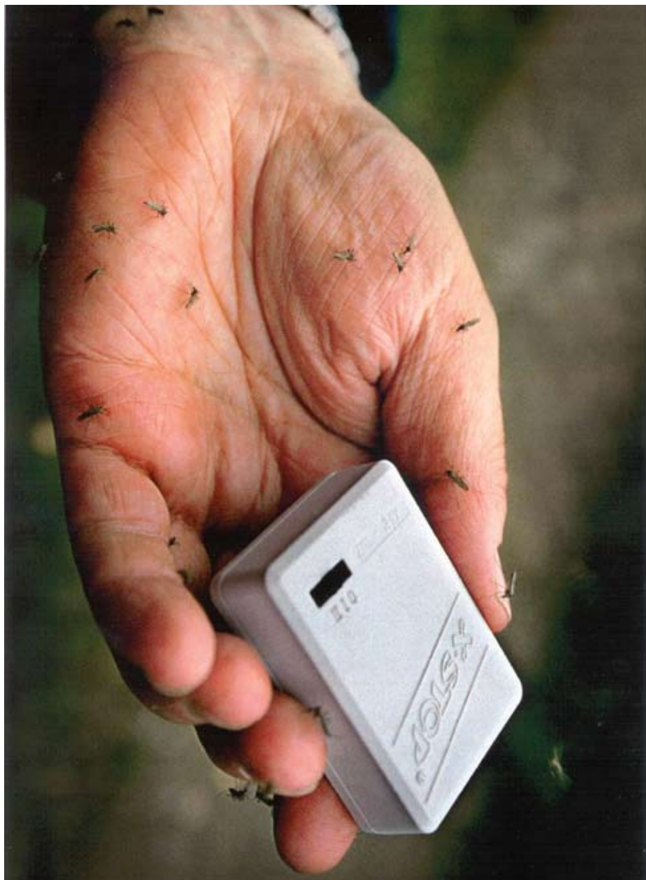
Utprøving av en myggskremmer med ultralyd. Myggen reagerer ikke, men suger blod tett inntil lydmaskinen. Foto: Reidar Mehl.
