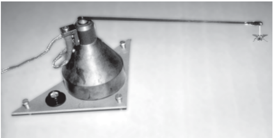
Figur 1. «Flight-mill» eller flygemølle for insekter.
